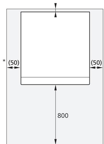
\* Una normale installazione richiede 300 – 400 mm (su qualsiasi lato) per il collegamento delle apparecchiature, quali il vaso di livello, le valvole e le apparecchiature elettriche.
