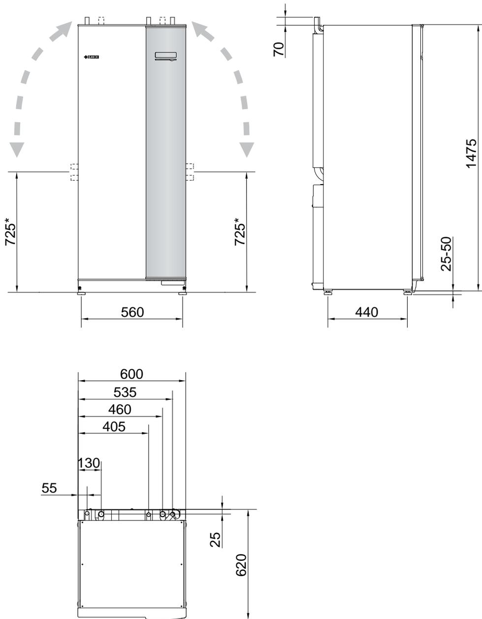
\* Questa dimensione riguarda i tubi del glicole a 90° (attacco laterale). La dimensione può variare di circa  $\pm 100$  mm in altezza poiché i tubi del glicole sono costituiti in parte da tubi flessibili.
